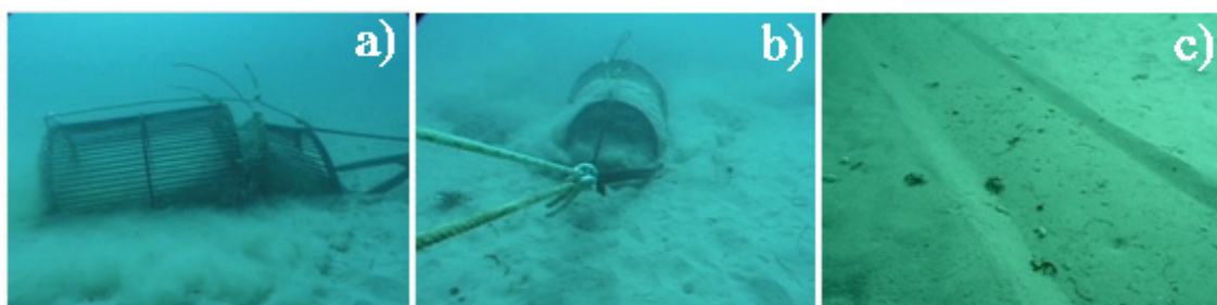
5449 Figura IV-87. a) Aspeto da ganchorra, b) seu modo de funcionamento e c) o respetivo 5450 rasto. (Fotografias: Miguel Gaspar).
